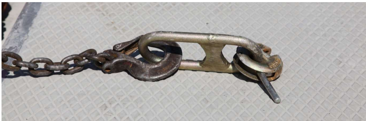
Kotwy mocujące typu PLA-RK-R1 5.0
